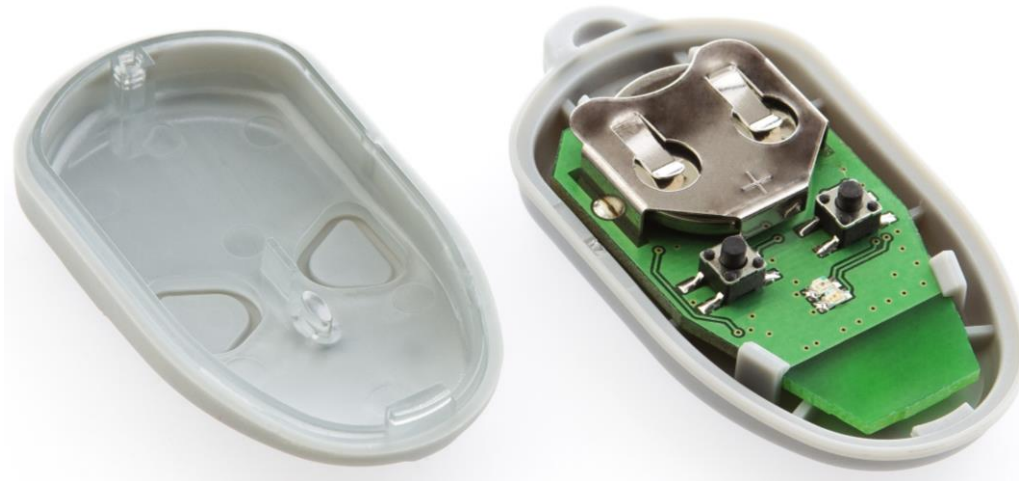
Рисунок 2. Идентификатор со снятой крышкой. Видна батарея питания
