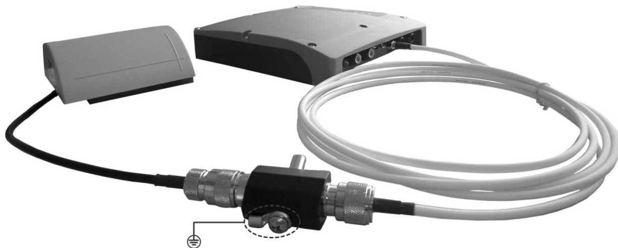
Рисунок 18. Установка грозоразрядника с комплектным кабелем
