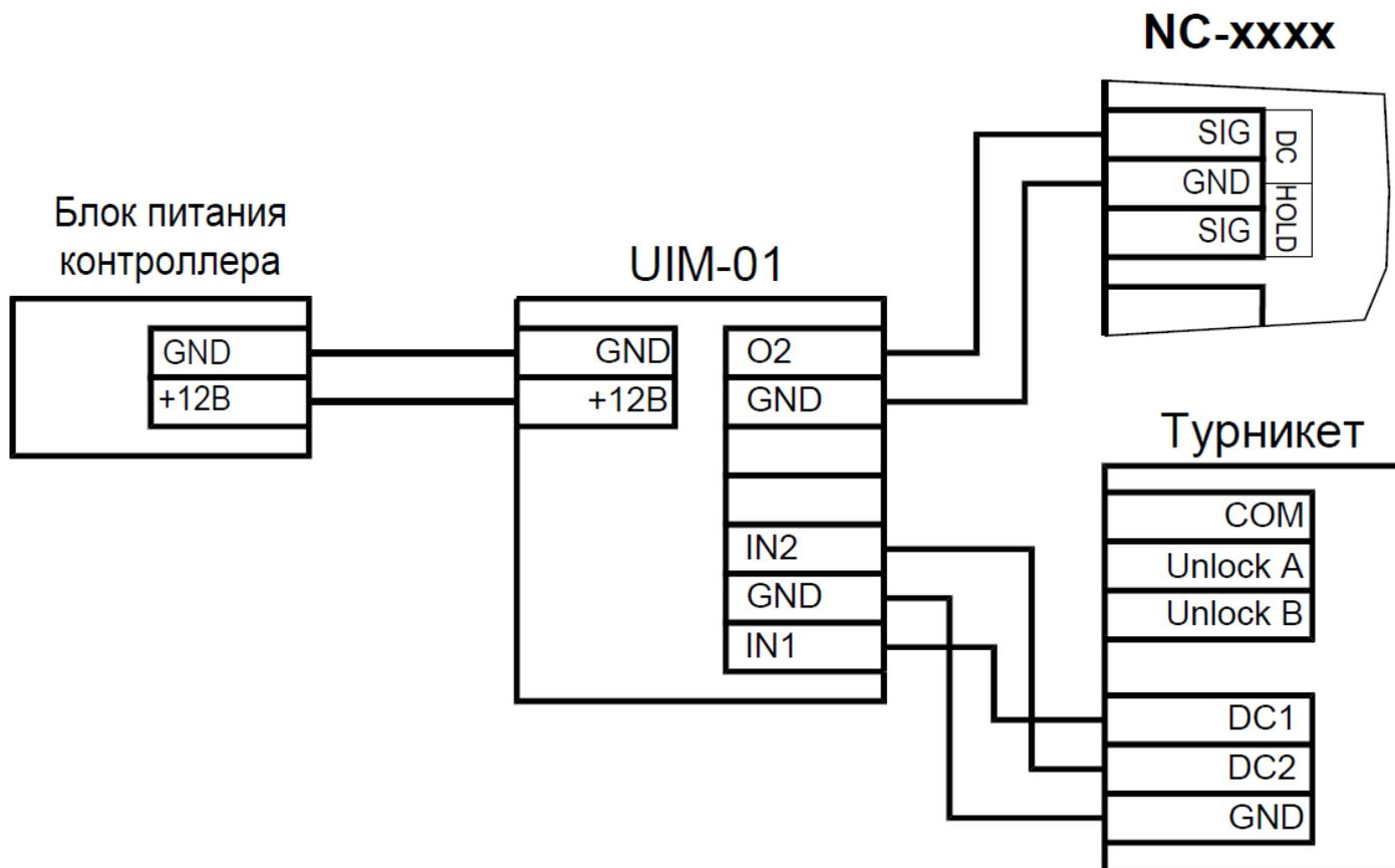
Рисунок 4. Подключение турникета с двумя датчиками проворота
