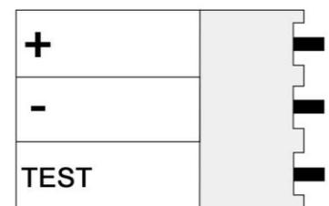
Рисунок 3. Назначение контактов разъема POWER
