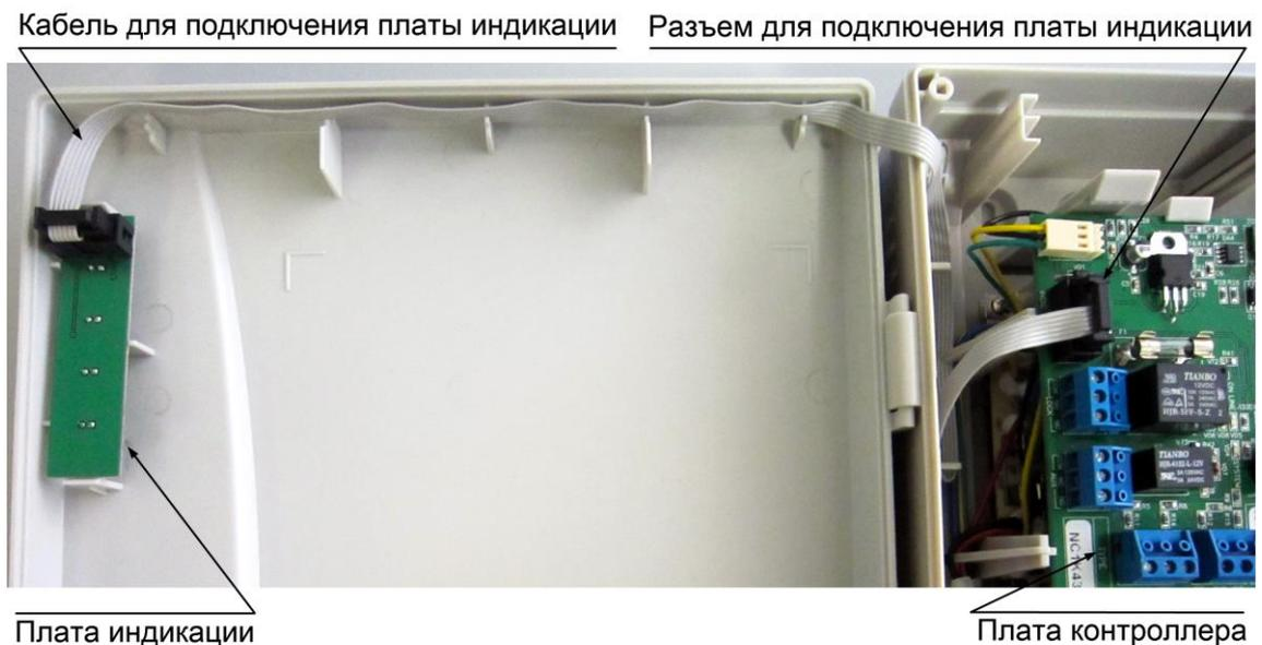
Рисунок 15. Схема подключения платы внешней индикации
