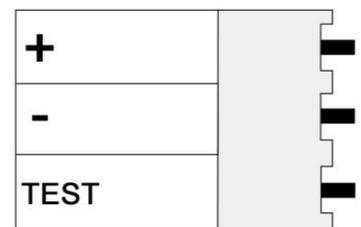
Рисунок 2. Назначение контактов разъема POWER
