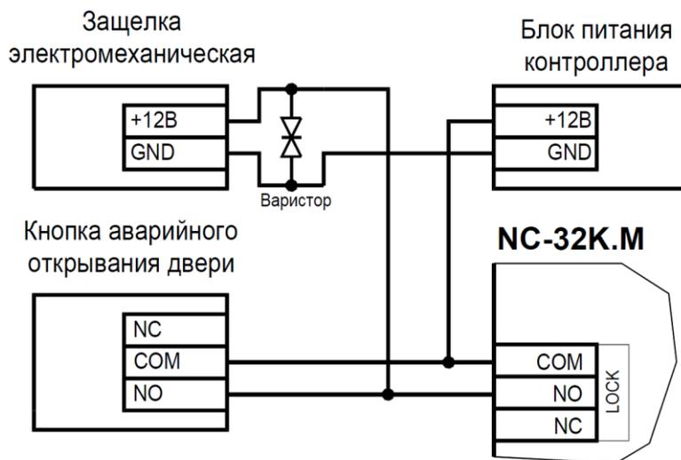
Рисунок 10. Подключение отпираемого напряжением замка к контроллеру
