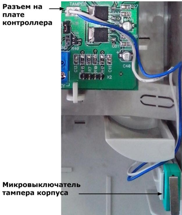
Рисунок 23. Подключение тампера корпуса
