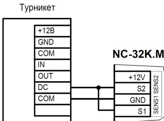
Рисунок 14. Схема подключения турникета с одним датчиком проворота
