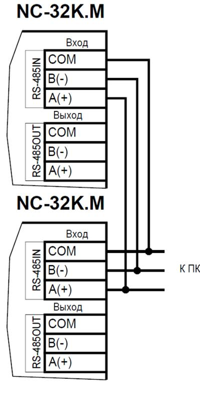
Рисунок 29. Соединение контроллеров по топологии «Звезда»
