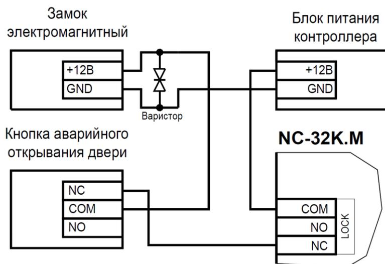
Рисунок 11. Подключение запираемого напряжением замка к контроллеру
