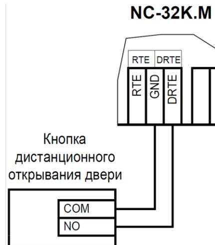
Рисунок 17. Схема подключения кнопки дистанционного открывания двери
