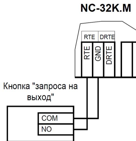
Рисунок 16. Схема подключения кнопки запроса на выход
