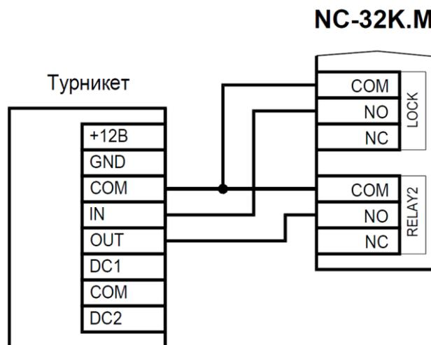
Рисунок 13. Подключение турникета к контроллеру
