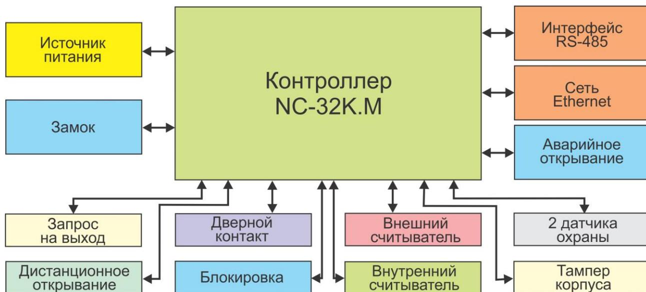
Рисунок 6. Оборудование, подключаемое к контроллеру NC-32K.M
