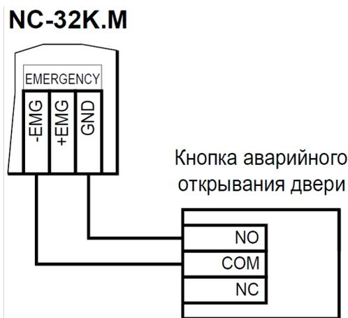
Рисунок 24. Подключение кнопки аварийного выхода к одному контроллеру
