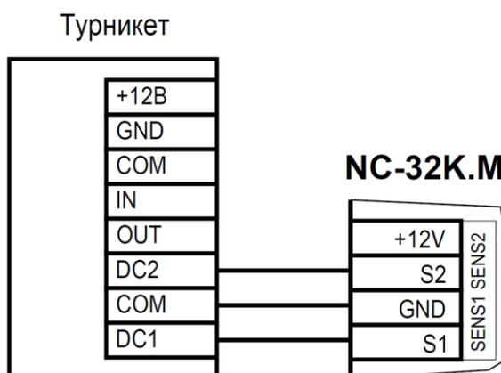
Рисунок 15. Схема подключения турникета с двумя датчиками проворота
